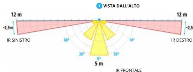
Con le testine laterali allineate i sensori laterali destro e sinistro hanno una portata ognuno di circa 12 m, per un totale complessivo di 24 m lineari, con apertura sul piano orizzontale di 10°.
