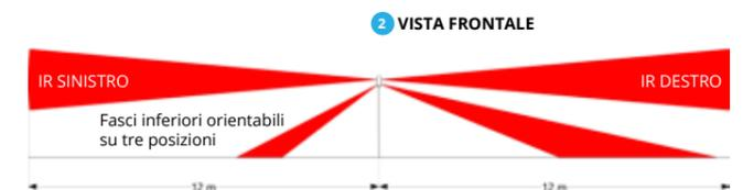
Ogni lato del Moskito dispone di una coppia di testine di rilevazione ad infrarossi (fig. C-2): testina superiore (rilevazione orizzontale o lontana) e testina inferiore (rilevazione verso terra o vicina). Quando il sensore lavora in modo NORMALE, l'allarme verrà generato solo se entrambe le testine di ciascun lato rilevano un'intrusione (AND).
