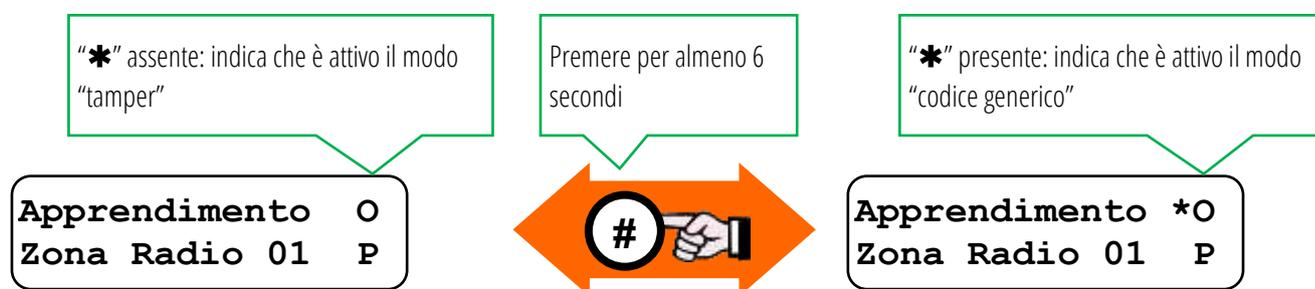
**La centrale riconosce il tipo di sensore e lo assegna automaticamente al tipo di inserimento corretto (es.: CTSR e DIRRVE a PARZIALE; DIRRV a TOTALE). E' possibile modificare questa assegnazione.**
